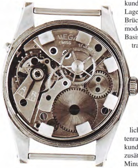
13 Omega-Armbandchronometer mit Kaliber 30, großes Modell mit Werknummer 10000001, etwa 1945, Zifferblatt- und Werksansicht
