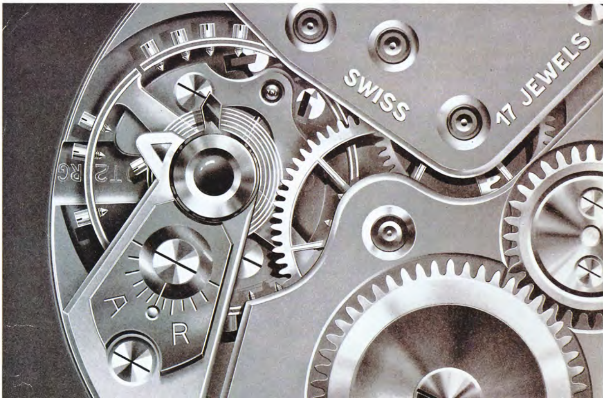
6 Die Feinregulierung des Kalibers 30 T2 Rg für Armbandchronometer
