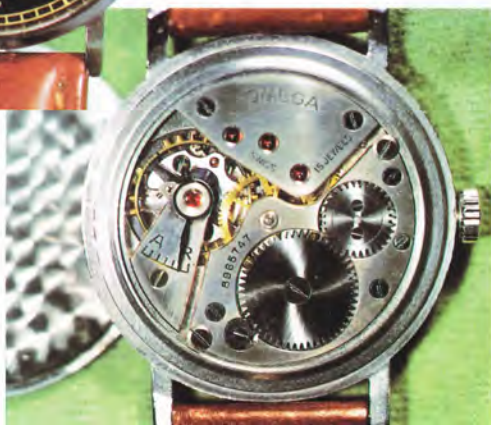
4 Omega-Armbanduhr Kaliber 30, Werknummer 8965 747 aus der ersten Serie von 1939
