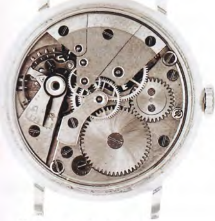
12 Omega-Armbanduhr mit Kaliber 30, mit kleiner und zugleich springender Zentralsekunde, Werk- und Zifferblattansicht
